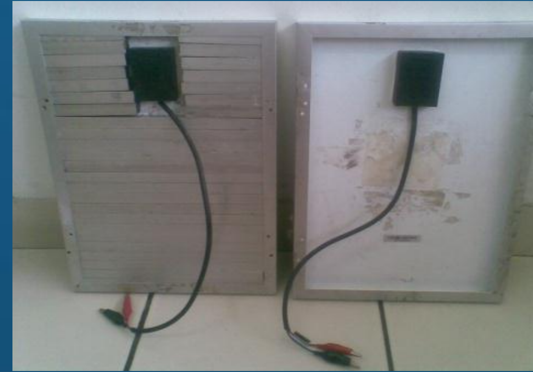
Gambar 4 Tampak belakang panel surya yang dipasang pendingin (kiri)
